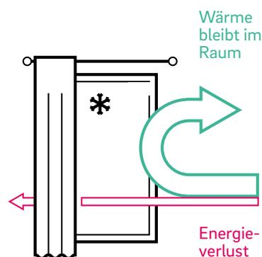
\* Standardfenster Mindestanforderung nach Energieeinsparverordnung 2014 (EnEV):  $U_w = 1,3 \text{ W}/(\text{m}^2\text{K})$ , Bestwert SYNEGO mit Mitteldichtungssystem:  $U_w = 0,76 \text{ W}/(\text{m}^2\text{K})$
